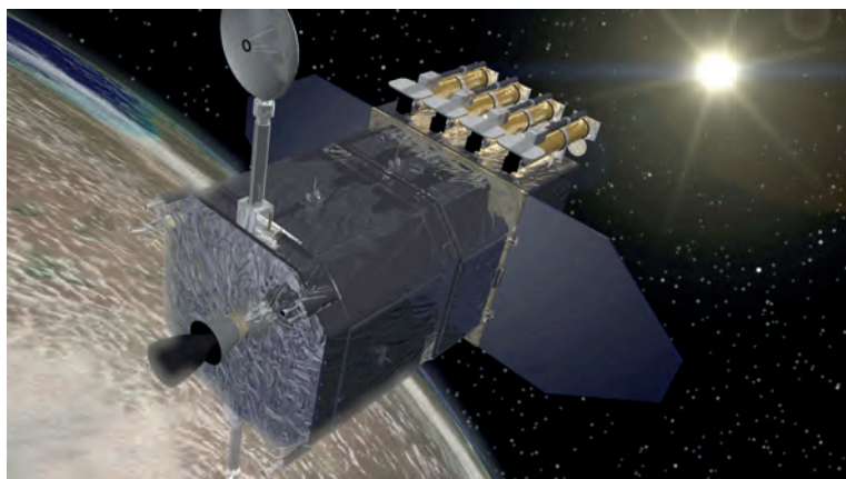
Obr. 14. Sluneční observatoř SDO pečlivě sleduje Slunce čtveřicí dvacetimetrových dalekohledů. Na palubě má také interferometr HMI, který je nejlepším přístrojem pro současnou helioseismologii.
