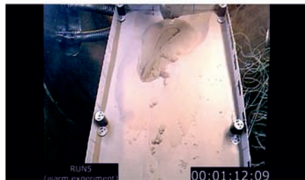
Experiment s vyléváním kapalné vody v prostředí sníženého tlaku na studený (označen jako RUN3) i teplý (označen jako RUN5) písek. Výrazné projevy levitujících hrud písku jsou k vidění na posledním obrázku. Převzato z Raack a kol. (2017).
