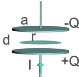
Použijte vektor intenzity elektrického pole  $\mathbf{E}$  z první úlohy a spočítejte tok elektrického pole tímto myšleným diskem o poloměru  $r < a$ , rovina disku je kolmá k vektoru  $\hat{\mathbf{k}}$ .
