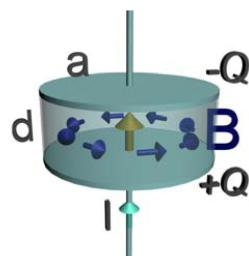
Spočítejte tok  $\iint \mathbf{S} \cdot d\mathbf{A}$  Poyntingova vektoru vyjádřeného pro  $r = a$  imaginárním válcovým pláštěm o poloměru  $a$  a výšce  $d$ . Výsledek by měl být vyjádřen pomocí  $Q$ ,  $a$ ,  $R$  a  $d$ . Jaká je jednotka výsledku?
