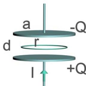
Zvolte si proto kružnici jako uzavřenou smyčku, kružnice je o poloměru  $r < a$  a je v rovině mezi deskami. Spočítejte křívkový integrál kolem kružnice  $\oint \mathbf{B} \cdot d\mathbf{s}$ . Výsledek vyjádřete
