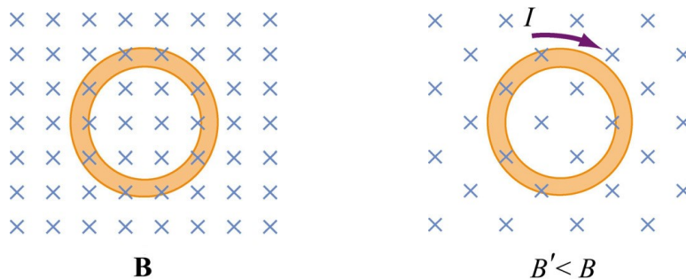
Obr. 10.1.3: Indukce elektromotorického napětí změnou velikosti \mathbf{B} .
