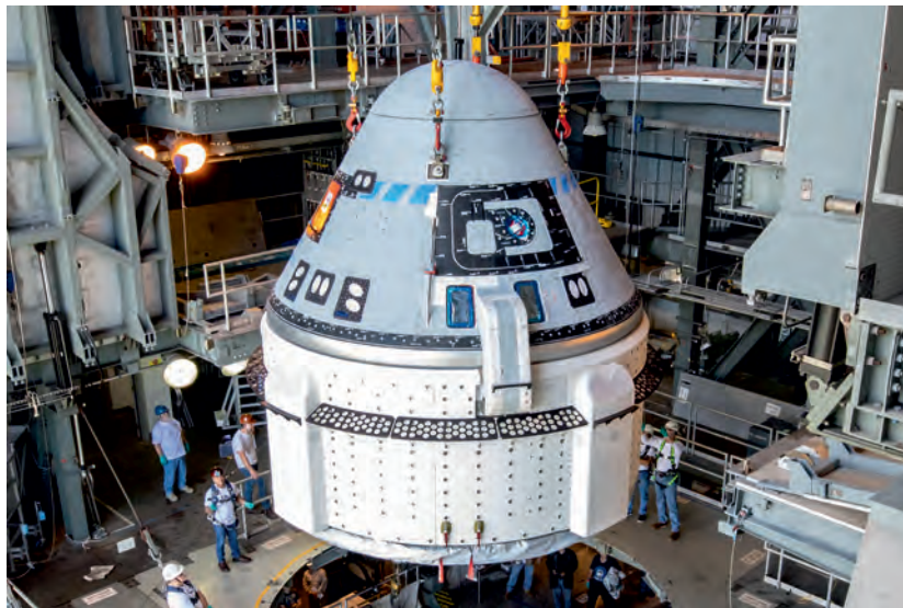
Připojování prototypu lodi Starliner společnosti Boeing k nosné raketě Atlas V aliance ULA před prvním letovým testem. Snímek lodi byl pořízen dne 21. listopadu 2019 v montážní hale VIF (Vertical Integration Facility) na startovacím komplexu 41 floridského mysu Canaveral. Zdroj: NASA, Cory Huston.
