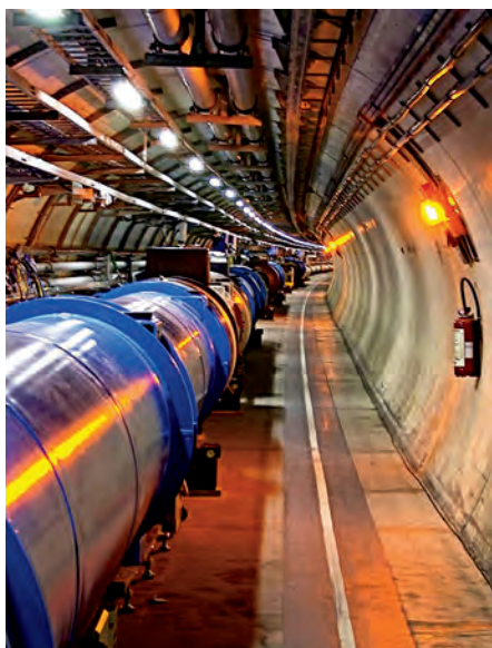
Rozluštit záhadu páté interakce by mohl největší urychlovač světa – Velký hadronový kolider v komplexu urychlovačů CERN v blízkosti Ženevy. Obvod urychlovače je 27 kilometrů a protony zde mohou získat energii až 14 teraelektronvoltů. Zdroj: CERN.
