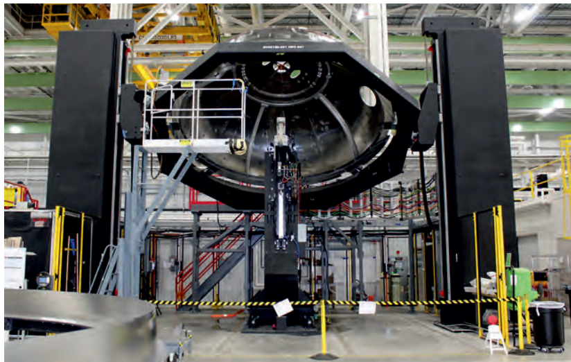
Svařování svrchní kopule druhého stupně nazývaného Centaur. Zdroj: SmarterEveryDay, ULA.
