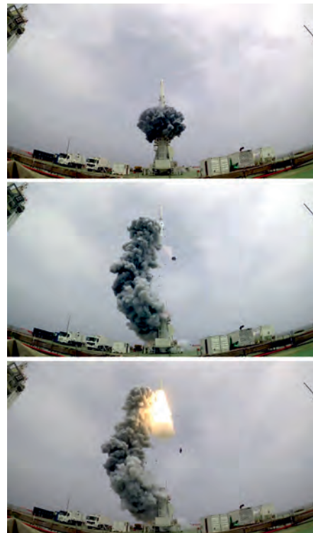
Úspěšný start rakety Dlouhý pochod 11 z plovoucí základny umístěné ve Žlutém moři. Na první fotografii je samotný start za pomoci stlačených plynů. Druhý a třetí snímek zachycují stav těsně před a těsně po zážehu raketových motorů. K zážehu motorů nedochází na plošině, ale až ve vzduchu, neboť by ji plameny mohly poškodit. Zdroj: China Central Television.
