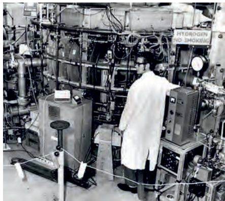
Tokamak CLEO (Closed Line Electron Orbit) v britském Culhamu. Zdroj: Oxford Mail.
