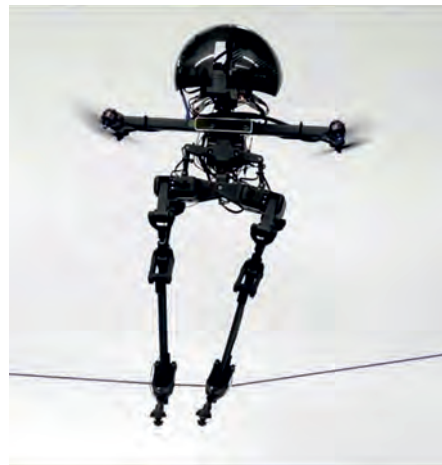
LEO je profesionální slackliner, je to kříženec mezi dronem a robotem, který dokáže pomocí nohou překročit tenký drát, než ladně doletí zpět na zem. Zdroj: WWC.
