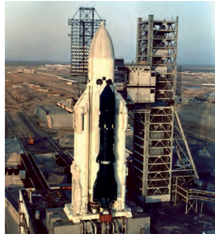
Sovětská raketa Enérģija s prototypem bojové družice Poljus připravená ke startu na kosmodromu Bajkonur. Zdroj: Neznámý.
