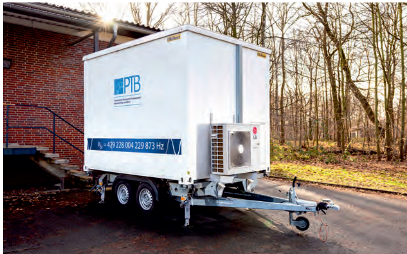
Mobilní verze optických atomových stronciových hodin. Nápis informuje kolemjdoucí vozidla o použité frekvenci. Zdroj: Physikalisch-Technische Bundesanstalt.
