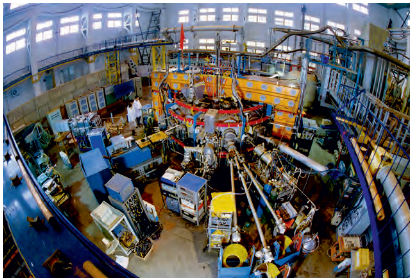
První supravodivý tokamak T-7, když pracoval v čínském Hefei jako HT-7 (demontován 2013). Zdroj: ASIPP.
