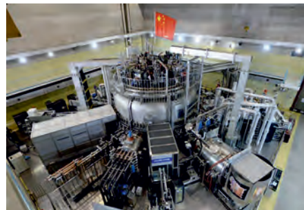
První plně supravodivý tokamak, čínský EAST (Experimental Advanced Superconducting Tokamak), který pracuje v čínské Hefei. Zdroj: VCG.
