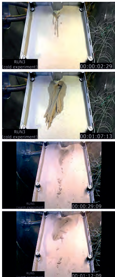
Experiment s vyléváním kapalné vody v prostředí sníženého tlaku na studený (označen jako RUN3) i teplý (označen jako RUN5) písek. Výrazné projevy levitujících hroud písku jsou k vidění na posledním obrázku. Převzato z Raack a kol. (2017).
