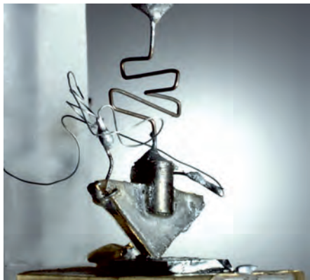
První tranzistor zkonstruovaný v Bellových telefonních laboratořích. Vývoj k první komerčně použitelné součástce trval pouhé čtyři roky. Rozvoj elektroniky, který následoval, nemá v historii civilizace obdoby a pokračuje dodnes. Zdroj: Bellovy telefonní laboratoře.
