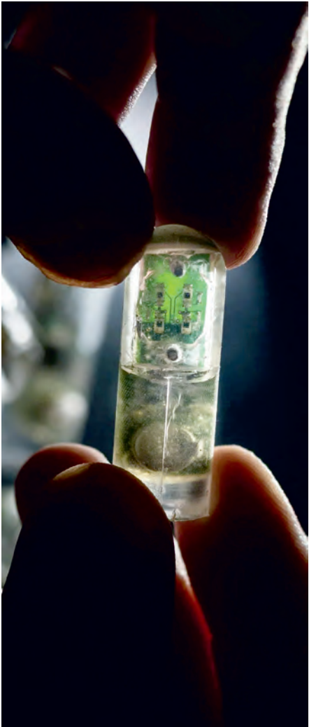
Ampule s elektronikou a geneticky upravenými bakteriemi, kterou lze spolknout. Elektronika snímá reakce bakterií na vnější podněty a vysílá je do chytrého telefonu. Zatím bylo testováno na zvířatech, pro člověka musí dojít k miniaturizaci. Zařízení je vhodné pro detekci krvácení střev, diagnostiku rakoviny střev a podobně. Zdroj: MIT.
