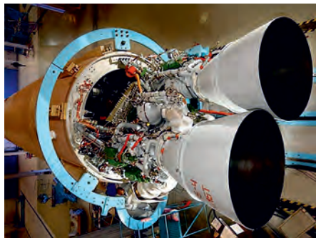
Špičkový ruský raketový motor RD-180 využívají i američané v raketě Atlas V. Zdroj: NASA.
