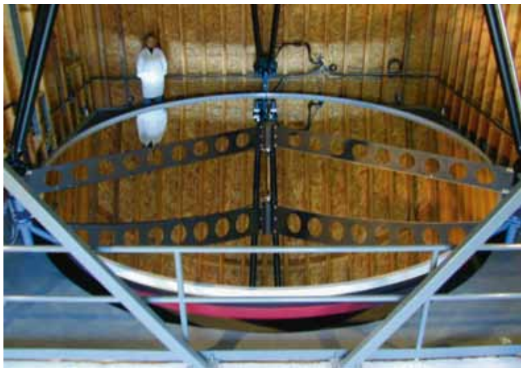
Obr. 23. Velký zenitový dalekohled (LZT) je šestimetrové kapalné rtuťové zrcadlo provozované Univerzitou v Britské Kolumbii, 70 kilometrů východně od Vancouveru. Zdroj: LZT.
