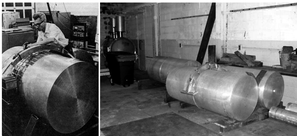
Obr. 3.32: Joseph Weber u jednoho z rezonančních válců (nalevo). Rezonanční válce připravované pro experimenty (napravo).
