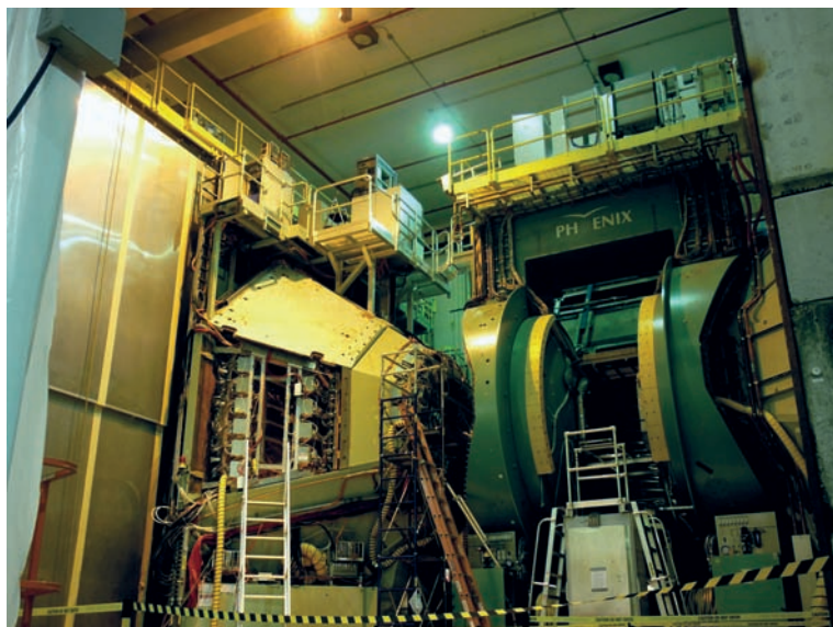
Obr. 27. Detektor Phoenix na urychlovači RHIC v Brookhavenské národní laboratoři na Long Island. V tomto zařízení se vyrábí kvarkové-gluonové plazma – pralátka, z níž vznikal vesmír. Zdroj: AGA.
