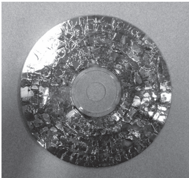
Typické obrazce vzniklé v kovové vrstvě cédéčka vlivem vířivých proudů. Zdroj: David Newman, University of Alaska.
