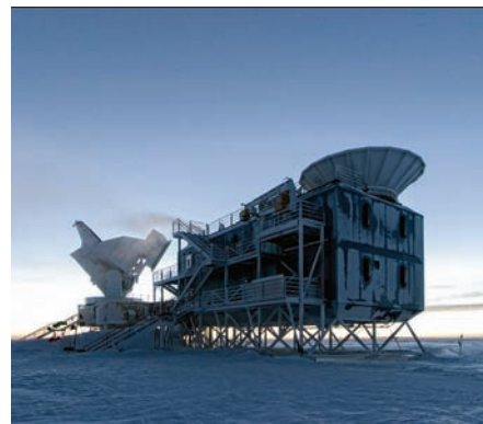
Přístroj BICEP2 na jižním pólu, který možná potvrdil inflační hypotézu a nepřímo objevil reliktní gravitační vlny. Vlevo vzadu se tyčí desetimetrový radioteleskop SPT. Zdroj: SPT/BICEP2.
