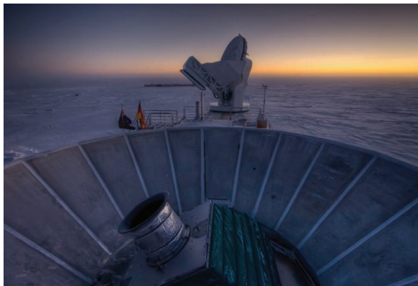
Pohled na horní část přístroje BICEP2 (v popředí) v době západu Slunce. Hlavní zařízení je v budově pod stínicí mísou. Zdroj: SPT/BICEP2.
