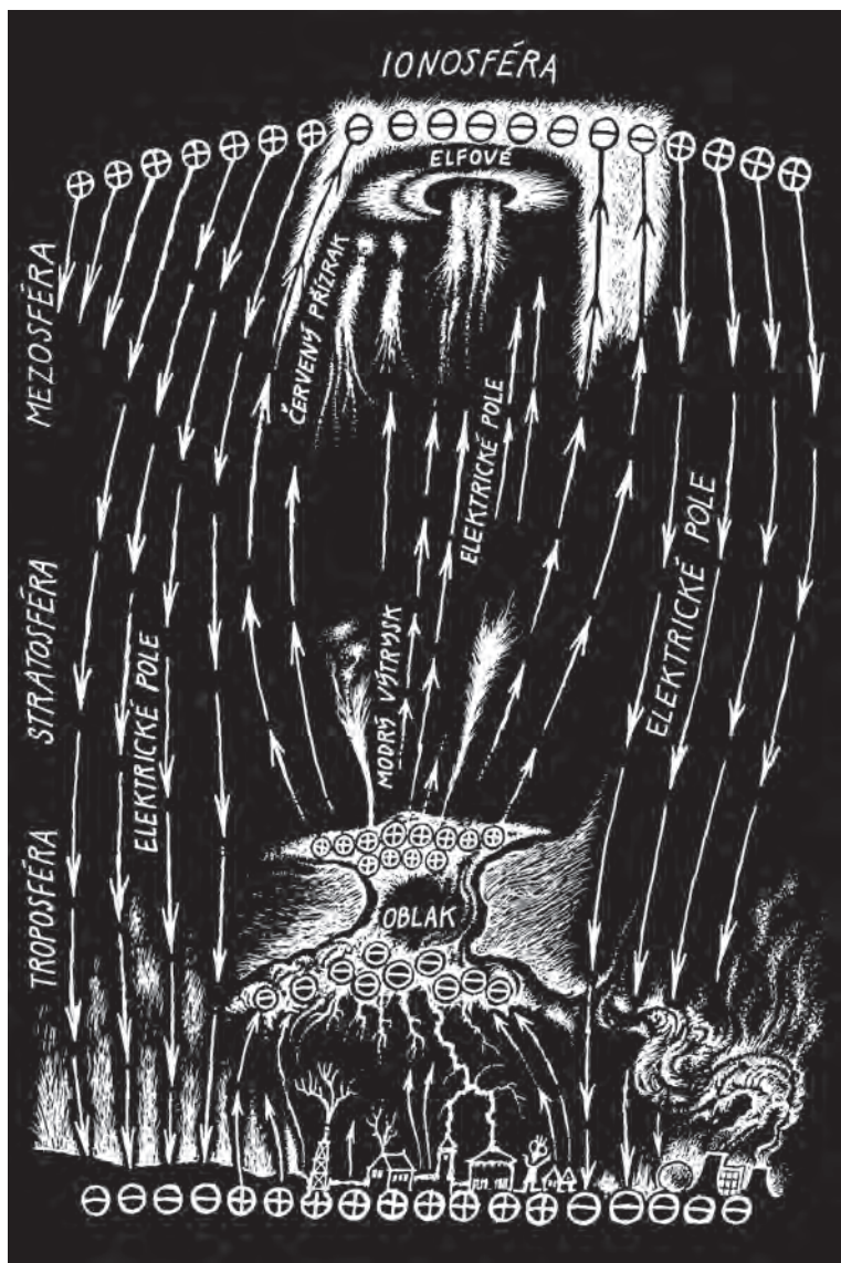
Obr. 3. Země a ionosféra tvoří obří kulový kondenzátor. Náboj země je záporný a ionosféry kladný. V místě, kde se nachází bouřkový mrak, se indukuje obrácené elektrické pole.
